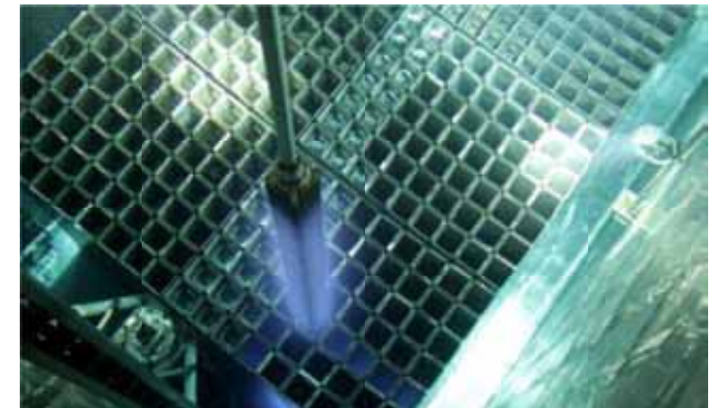
Movimentação de combustível usado na piscina de Angra1
